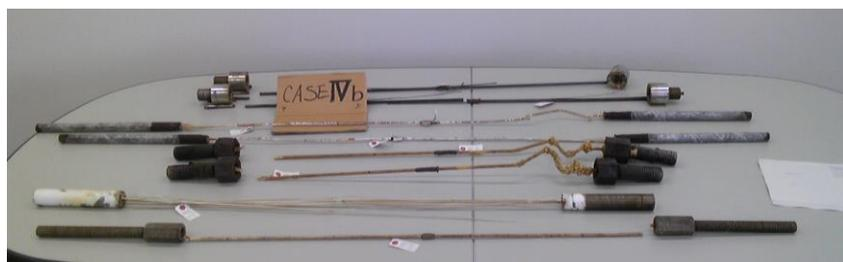
●試験後の各種 FRP 緊張材（写真上）
