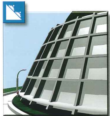
グラウンドアンカー
